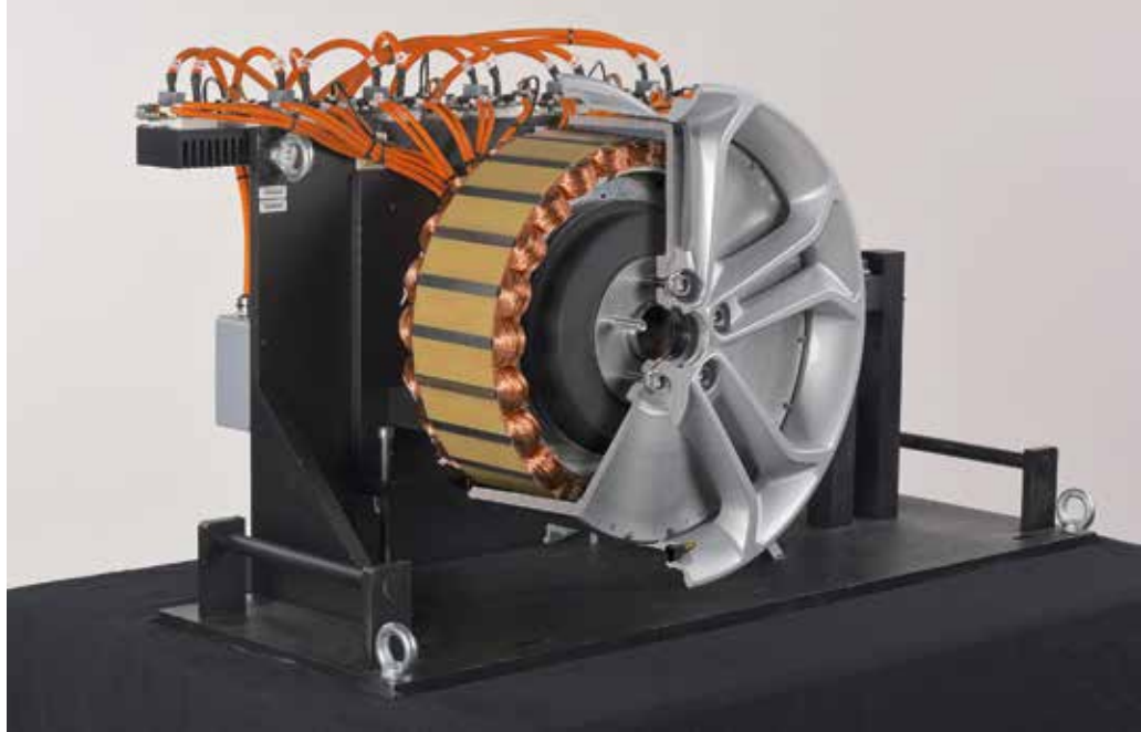
Reluktanz im Rad: Am Institut für Automatisierungstechnik der TH Köln wurde ein Radnabenmotor mit integrierter Leistungselektronik auf der Basis einer geschalteten Reluktanzmaschine entwickelt. Der Motor soll demnächst in einem umgerüsteten Ford Focus Electric getestet werden. (Foto: TH Köln)
